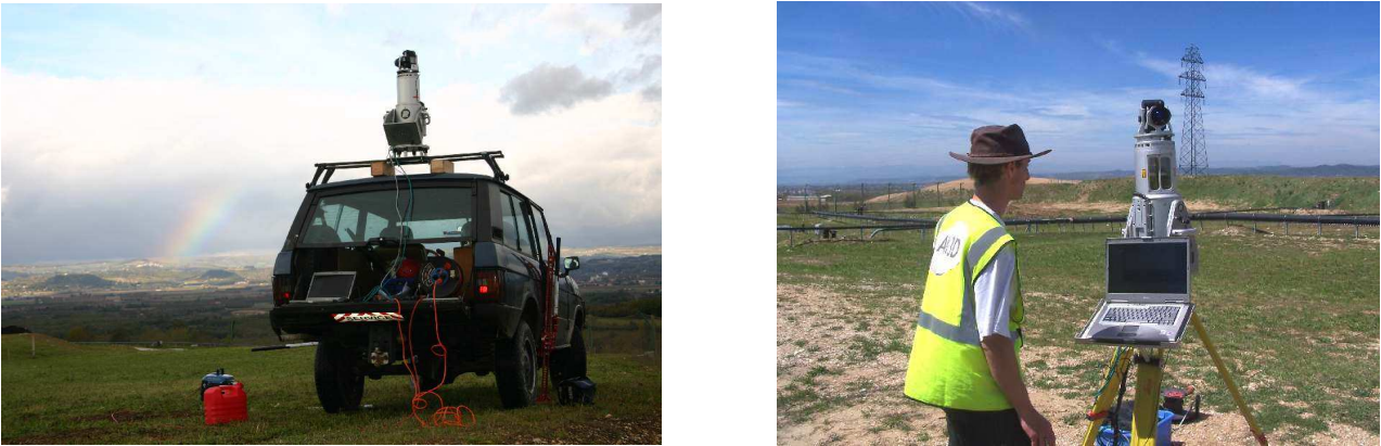
Figure 2. Appareillage scanner laser 3D (Riegl LMS-Z420i) testé sur le site de Chatuzange (a) appareillage embarqué (b) appareillage sur pied (ATM3D : < www.atm3d.fr >)
