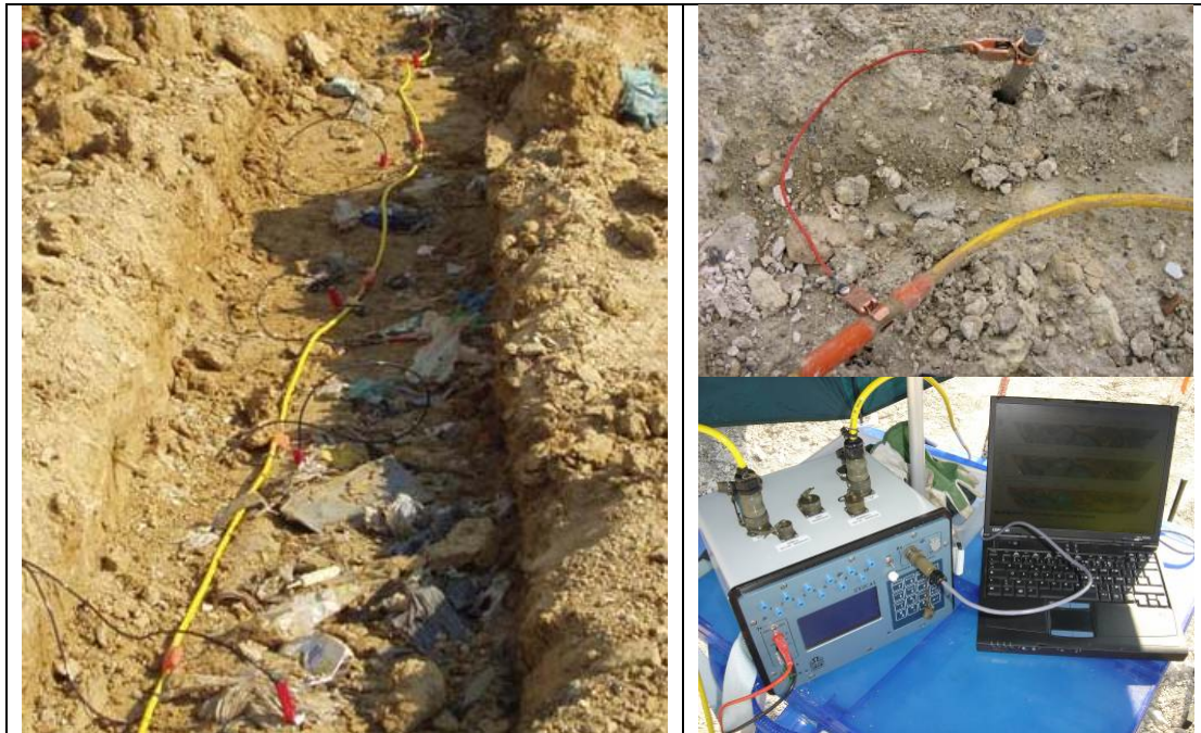
Figure 86 : Electrode géophysique et dispositif d'acquisition
