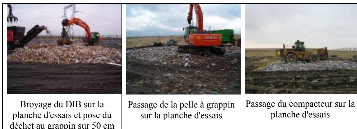
Figure 24 : Essai préliminaire de l'impact de la compaction sur la densité pour différents types de déchets
