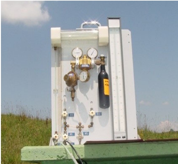
Figure 20. Tassomètre LCPC (a) Mesure sur le CSD de Torcy (b) Schéma de l'appareillage complet (Filliat, 1981).
